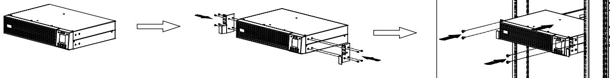
**ПРИМЕЧАНИЕ.** В связи с большим весом оборудования обязательным требованием является использование кронштейнов для монтажа в стойке (направляющей с L-образной опорой). По той же причине рекомендуется устанавливать блок батарей для ИБП в нижней части корпуса стойки.
